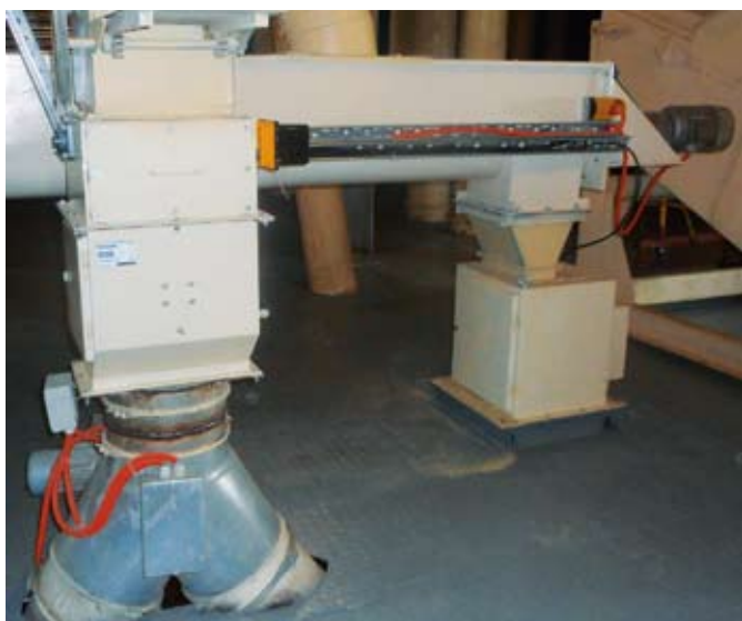
Рис. 2. Дозатор зерна непрерывного действия (слева) и измеритель массового расхода комбикорма (справа)
