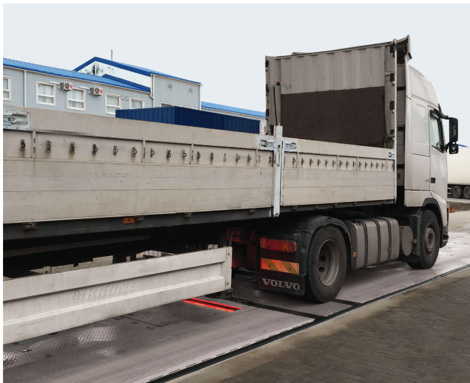
Рис. 1. Блок досмотра днища автомобиля
