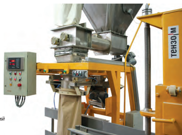
Универсальный дозатор «UNIBAG» способен в течение нескольких минут перестраиваться на заполнение стандартных или клапанных бумажных мешков
