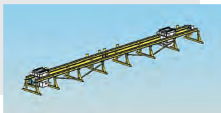
Для подачи средних и микрокомпонентов в смеситель используются 2 челночных бункера системы «SHUTTLEBOX», которая позволяет сохранять состав без качественных потерь и изменений
